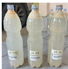
Gambar 5. Pengolahan Limbah Cair Dapur Menggunakan EE Secara Aerob Dengan Aerator
