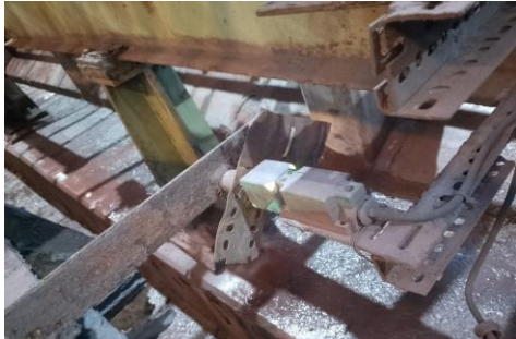
Gambar 4. Sensor proximity pada colling bed
