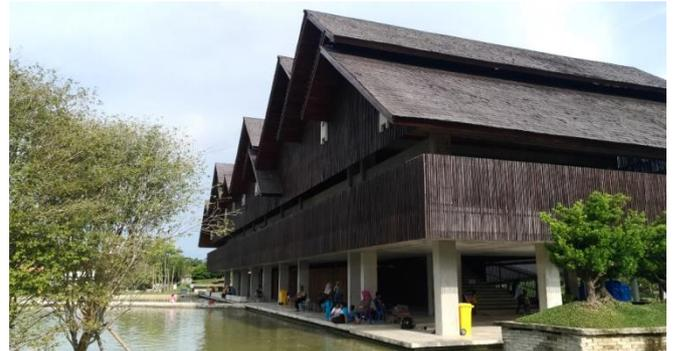
**Gambar 5.** *Design* bangunan yang dibiarkan terbuka sehingga mengurangi konsumsi listrik untuk lampu dan AC
